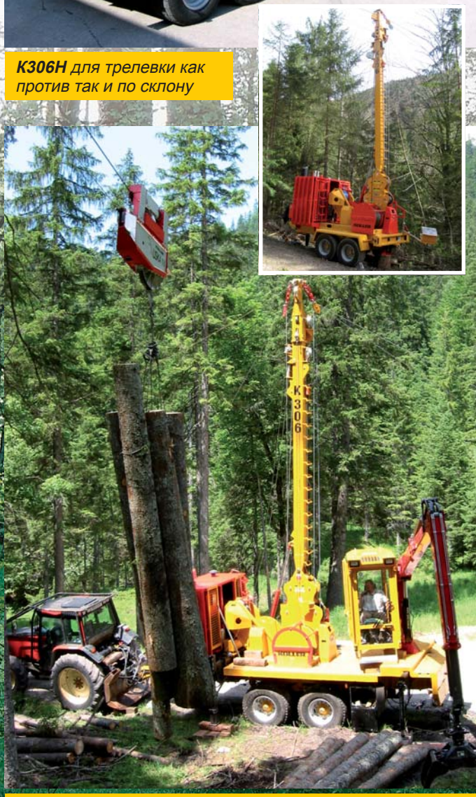
К306Н с краном как против так и по склону
