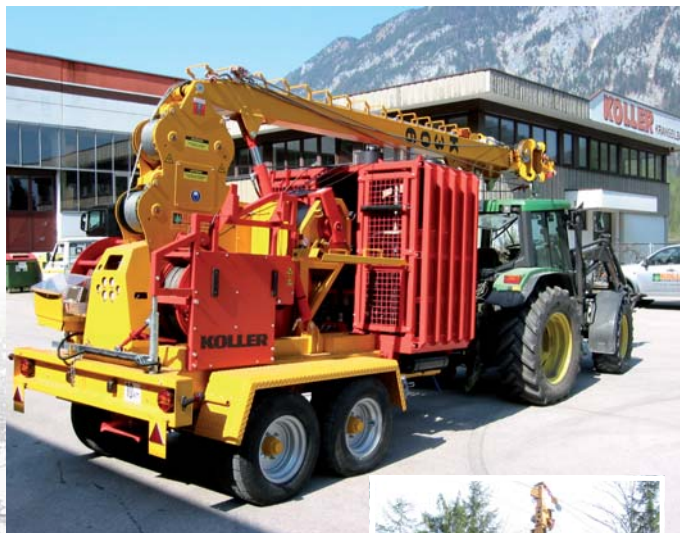
К306Н для трелевки как против так и по склону
