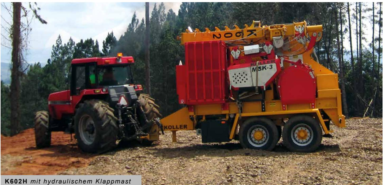
**K602H mit hydraulischem Klappmast**
