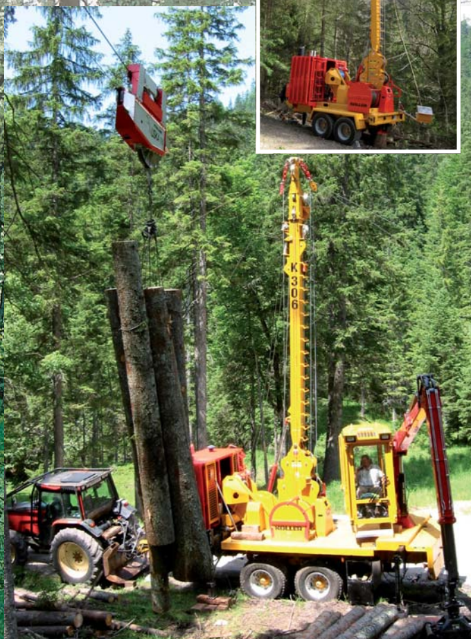
K306H クレーン装備の上げ荷・下げ荷兼用タワーヤード
