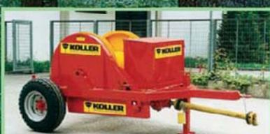
Carro para Desbobinamento de Cabos
