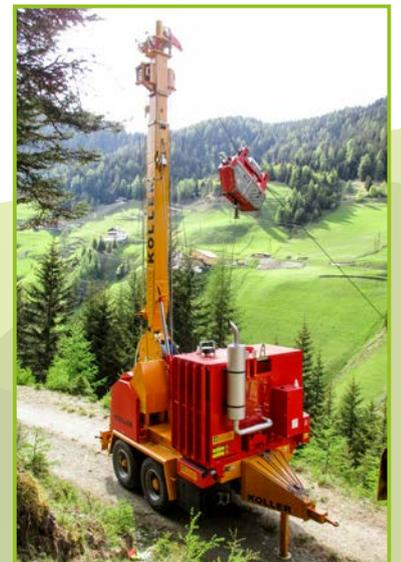
Der **K 602c-H** ist ein starkes Kippmastgerät zur Bergaufseilung und mit optionaler Rückholseiltrommel auch zur Bergabseilung sowie ebenes Gelände. Es wird hauptsächlich zur Vor- und Endnutzung eingesetzt. Als Fahrgestell wird ein Tandemachs-Anhänger mit Druckluftbremsanlage verwendet.
