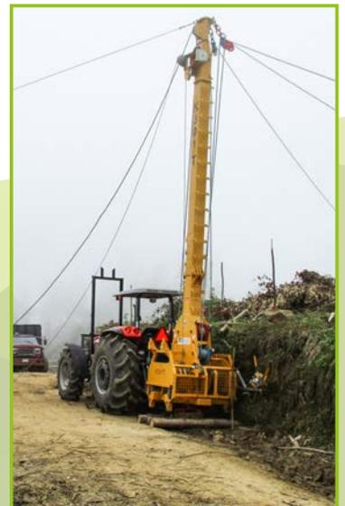
Beim **K 301-T** handelt es sich um ein Traktorbaugerät mit Dreipunktaufhängung zur Bergaufseilung. Er überzeugt durch einfachste Bedienung, zuverlässige und robuste Bauweise sowie kurze Montage- und Demontagezeiten im Einsatz. Speziell geeignet für Durchforstung und kleine Endnutzung.
