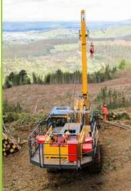
Der **KX 304** ist ein Bagger-Yarder für Berauf als auch Bergabseilungen mit einer optionalen Montageseilwinde. Es wird hauptsächlich für Durchforstung und Vornutzung verwendet. Kann aber auch in der Endnutzung eingesetzt werden.
